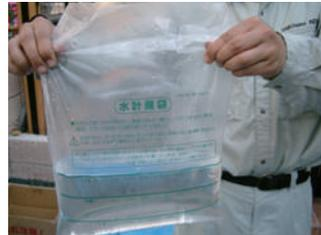
目詰め材の水量を測る際、台秤がない場合は、付属の水計量袋を使用して水量を一定にしてください。
