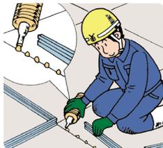
■補修用エポキシモルタルのバインダー (珪砂5～6号1.5kg/1セット)
